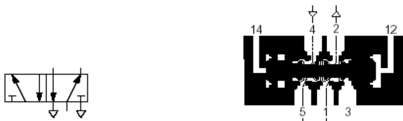
• Figura 8 - Valvola 5/2 con azionamento pneumatico (Simbolo grafico e schema costruttivo).
