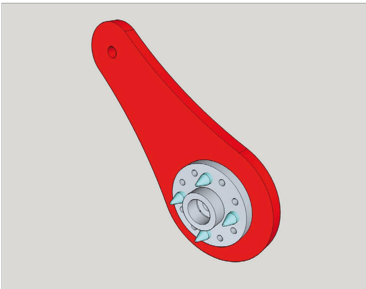
Ruotare tutto in senso orario il perno del servo montato sulla **spalla SX** quindi applicare su di esso la **leva 1** orientandola esattamente come mostrato nell'immagine seguente.
