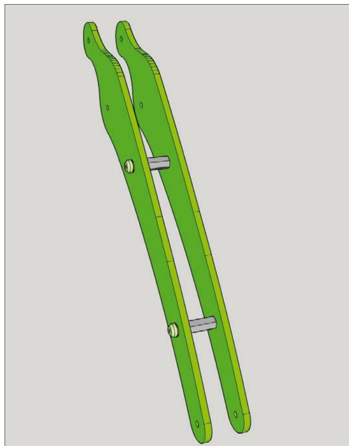
Prendere il **braccio1\_S** (in plexiglass da 3 mm) e fissare ad esso l'**HUB servo** (presente nella confezione del servo) e il **distanziale HUB** esattamente come in figura utilizzando 4 **viti autofilettanti 2,5x10 TB a croce** ed altrettante **rondelle piane 3x6**.
